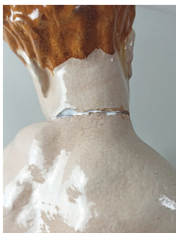
Obr. 23 Nově sestavený lepený spoj / Newly assembled glued joint
