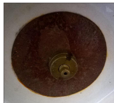
Obr. 5 Detail montáže vázy č. 1, gumová podložka a mosazný šroub / Detail of the assembling of the vase no. 1, rubber coaster and brass bolt
